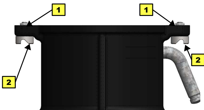
Obr. 9: Poloha nýtů pro čtyřtákní PJ (nastaveno z výroby)
