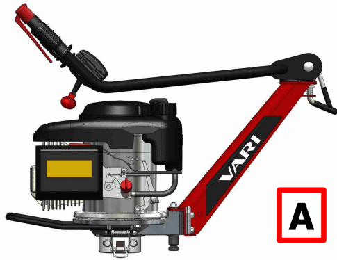
Obr. 10: Polohy model vodících rukojetí – varianty přepravní a skladovací polohy
